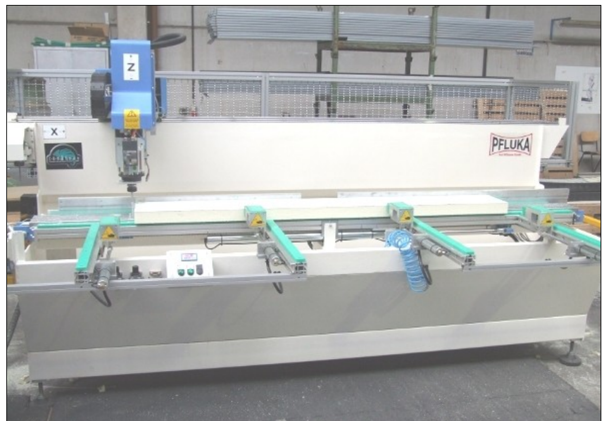
Die Pfluka-Sondermaschine mit pfiffigen Details wie automatischer Längenmessung der aufgelegten Werkstücke. Diese Option wird über die Programmiersoftware NC-luX ausgewertet.
