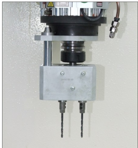
Die Montagebohrungen der Scharniere erfordern genau dieselben Abstände. Dafür entwickelte Pfluka einen Doppel-Spindelbohrkopf.
